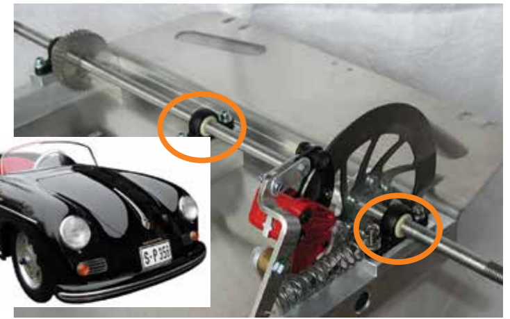
igubal®-Stahlager in einem elektrisch betriebenen Kinderauto igubal® pillow block bearings in an electrical vehicle for kids
