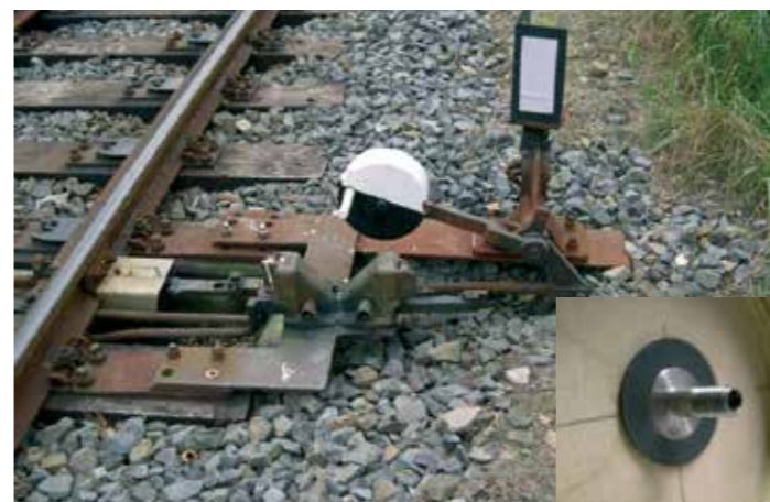
Weichenbetätigung und Führung für eine 180°-Drehbewegung mit einem Flanschlager aus iglidur® G Points activation and guidance for a 180 degree rotating motion with a flange bearing made of iglidur® G
