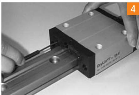
Sollte das Spiel zu eng eingestellt worden sein, so dass der Führungsschlitten klemmt, genügt es nicht, nur die Inbusschrauben zurückzustellen. Betätigen Sie nach dem Zurückschrauben zusätzlich den Rückstellknopf auf der den Schrauben gegenüberliegenden Seite des Führungswagens, um die Gleitelemente wieder zu lösen. Benutzen Sie dafür einen Stift folgender Größe: 2,5 mm für TW-01-20, 3,0 mm für TW-01-25, 3,0 mm für TW-01-30. Beginnen Sie den Einstellvorgang erneut.
